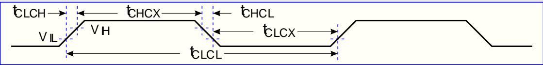
図 21-2 外部 クロック駆動波形
